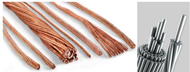
Figura 7.1.3. Materiales conductores (cobre y aluminio).
